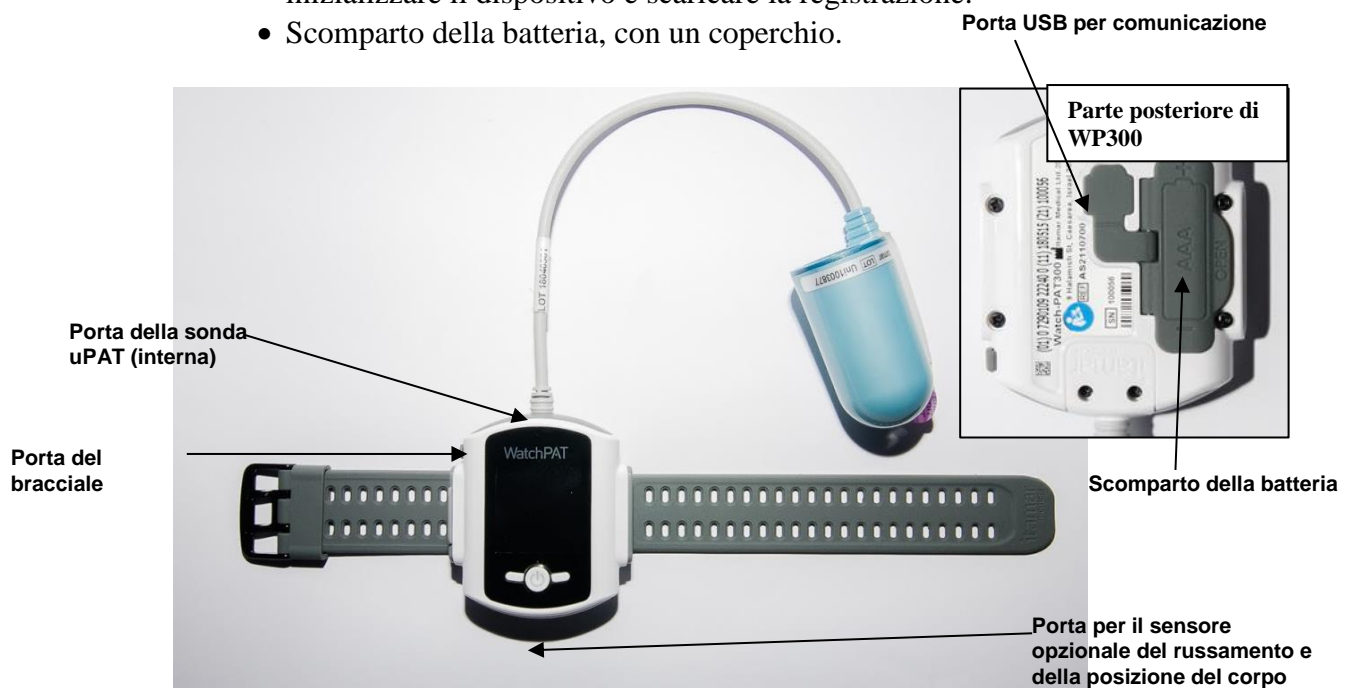
Figura 4 – Porte di manutenzione e periferiche
